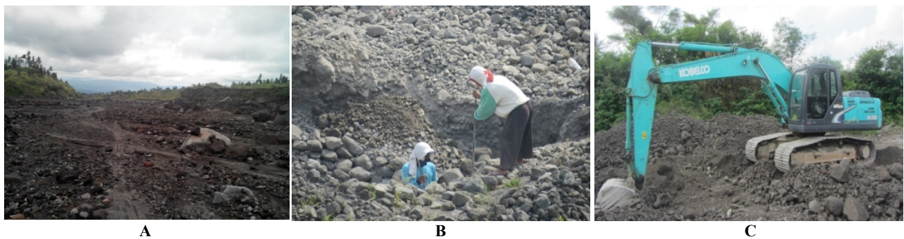
Gambar 2. A. Potensi pasir di Jurang Jero, B. Penambangan pasir manual, C. Penambangan pasir mekanis
