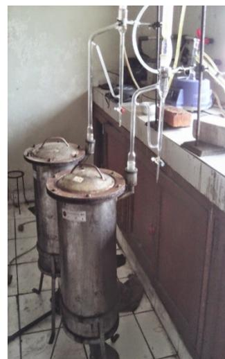
Gambar 2. Alat suling sistem kukus
