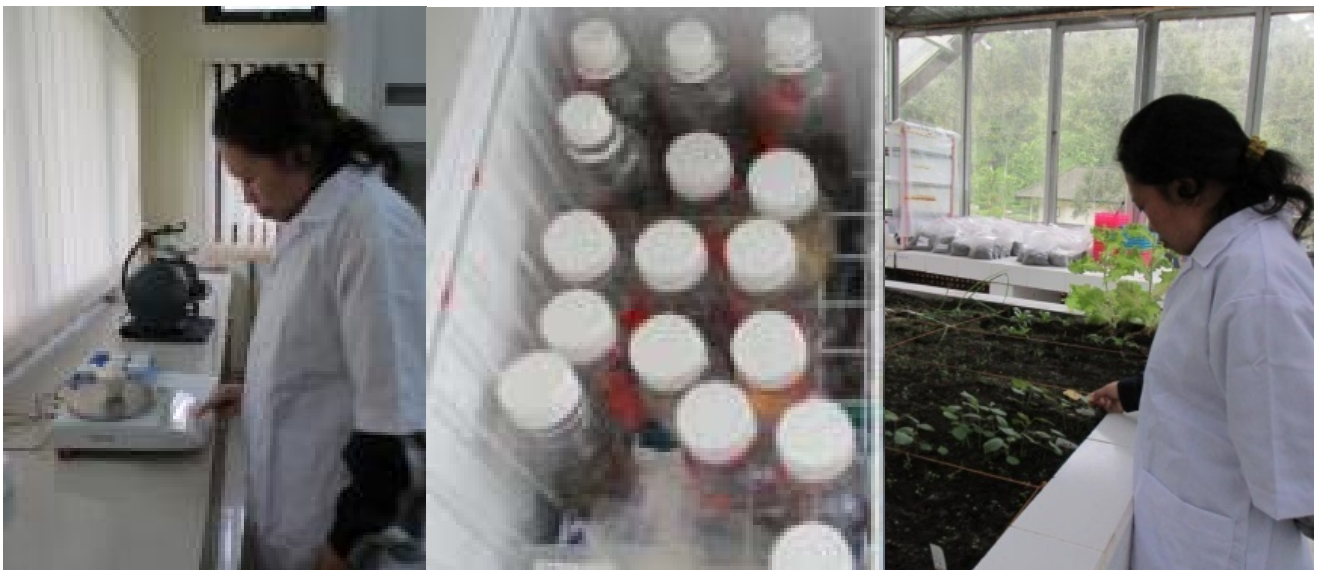
Gambar 2. A. Pengukuran kadar air pra dan pasca simpan. B. Penyimpanan biji ortodoks pada suhu -20^{\circ}\text{C} . C. Pengujian viabilitas dengan tes perkecambahan di bak pasir
