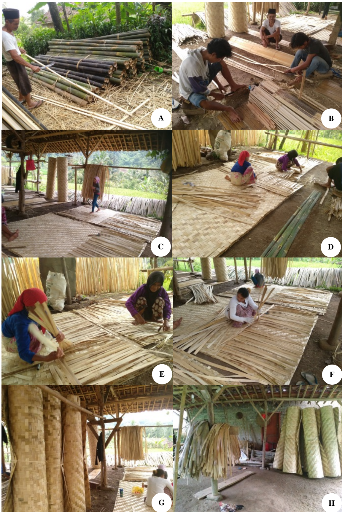
Gambar 2. Proses pembuatan bilik di Desa Cijedil, Cianjur, Jawa Barat. A. Pemotongan dan pembelahan, B. Ngahua (membagi lapisan bambu), C. Penjemuran, D. Penganyaman, E. Bilik siap dijual atau digunakan
